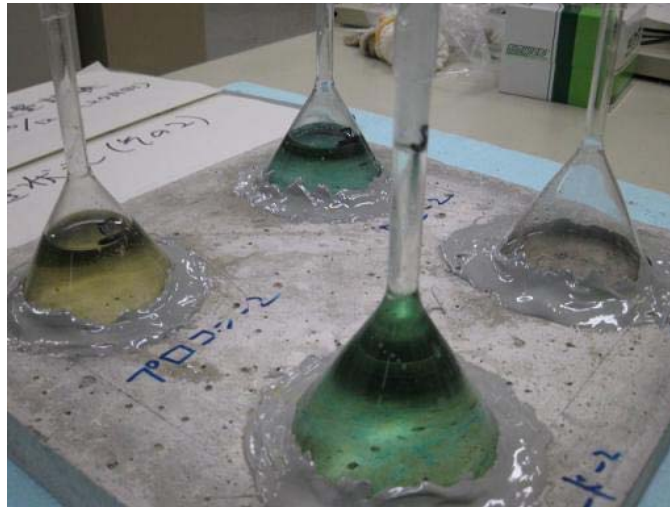
透水量試験実施状況
