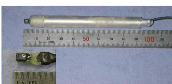
って誤差は直線的に増加し、0または100% R.H.での誤差は±4.0%R.H.である。センサーは写真-3に示すように、供試体に設けた測定孔への挿入時に先端部周辺が内壁に密着するよう作製したアルミ製プローブの先端部に取り付けた。プローブ挿入時は、水分が散逸しないよう測定孔をパテで密閉した。測定にあたっては、測定日前日に供試体を20±2°Cの室内に移し、測定値が安定するセンサー挿入後120分経過時の値を測定値とした。
